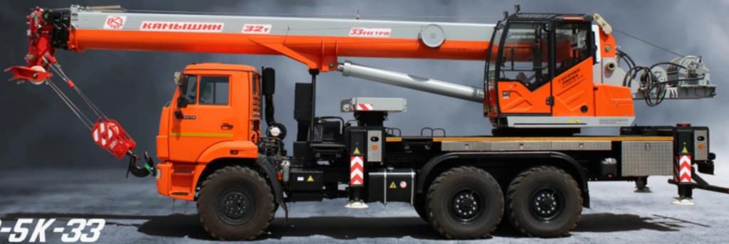
Кран автомобильный КС-55729-5К-33 предназначен для производства погрузо-разгрузочных, строительно-монтажных и других грузоподъемных работ на рассредоточенных объектах. После определённых доработок по заявке покупателя, кран способен выполнять рабочие операции, как с обычными, так и с опасными грузами.
