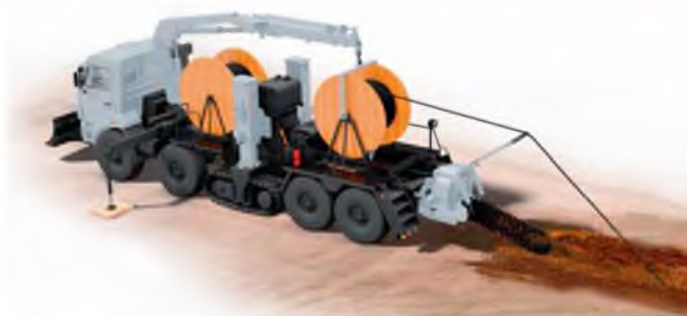
Функционал колёсно-гусеничного барового кабелеукладчика
