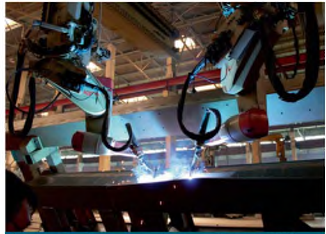
Австрийский роботизированный сварочный комплекс IMG сокращает время сварки и улучшает качество швов
