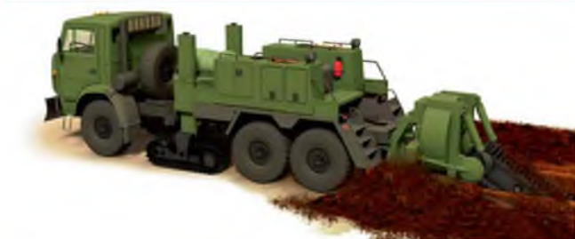
Полковая землеройная машина ПЗМ-2М на колёсно-гусеничном шасси КАМАЗ-65224
