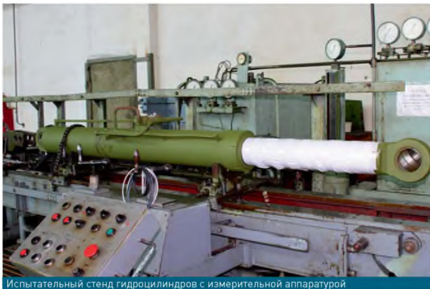
Испытательный стенд гидроцилиндров с измерительной аппаратурой
