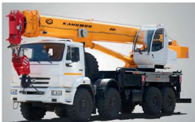
40-тонный «Камышин» КС-65740-4 на полноприводном шасси КАМАЗ-63501
