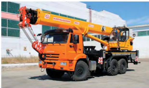
Ключевое место в программе 25-тонников «Камышин» принадлежит моделям с 31-метровой стрелой овоидного профиля [на фото: КС-55713-5К-4 на шасси КАМАЗ-43118]
