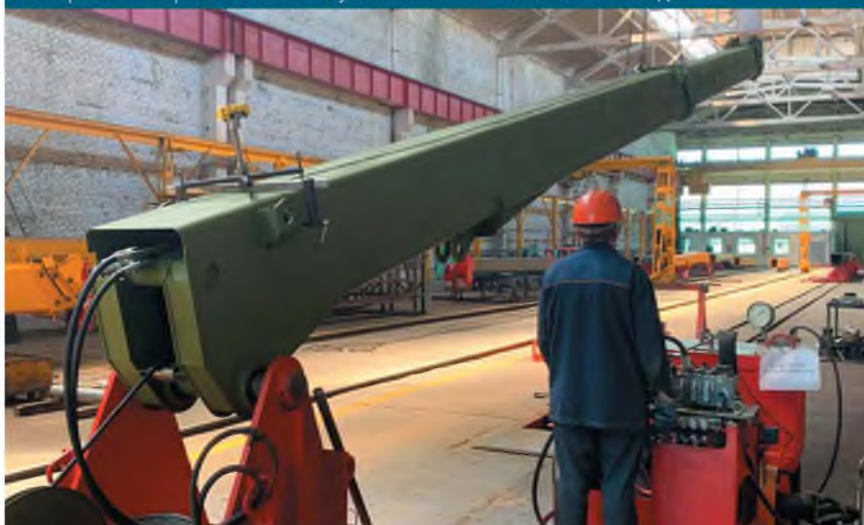
Тестирование стрелы МАО-40 на уникальном испытательном стенде
